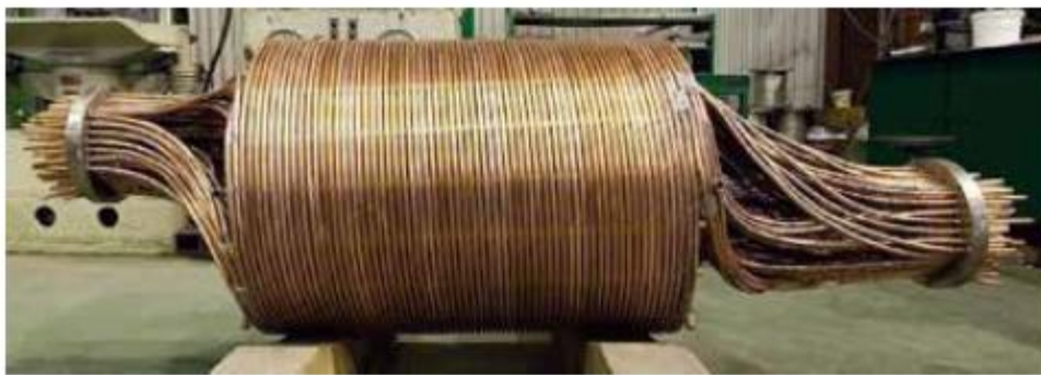
Рис. 5.1 – Спирально-навивные теплообменники (SWHE) — используются на крупнотоннажных заводах.
