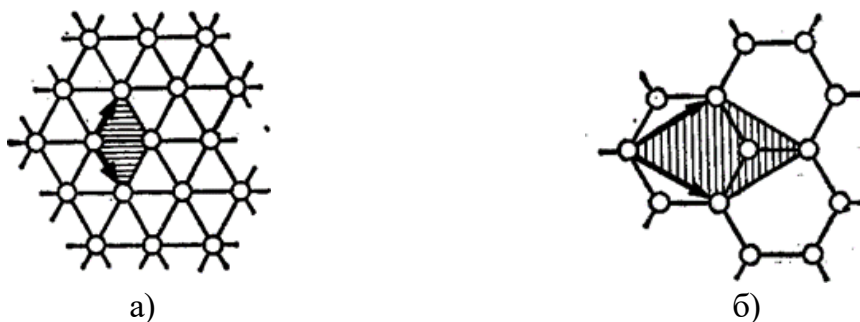
Рис. 60. Гексагональная двухмерная решетка и ее элементарная ячейка (заштрихована): а – сложная, б – простая
