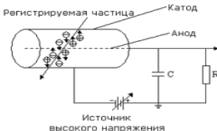
Рисунок 2. 4 – Принципиальная схема конструкции ГС
