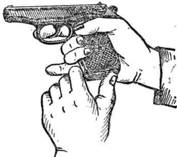
Рис. 3. Извлечение магазина из основания рукоятки
