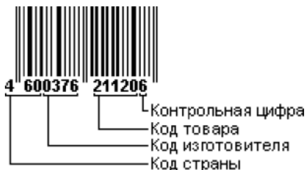
Рисунок 5.1 – Расшифровка штрих-кода Расчет контрольного разряда
