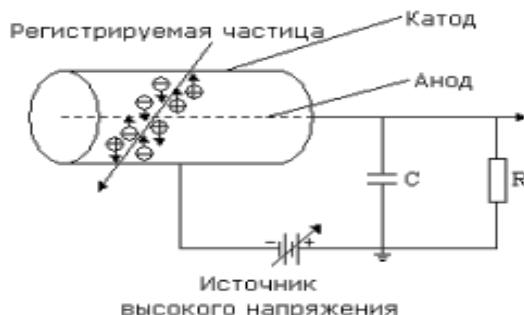
Рисунок 2. 4 – Принципиальная схема конструкции ГС
