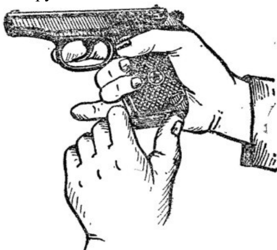
Рис. 3. Извлечение магазина из основания рукоятки
