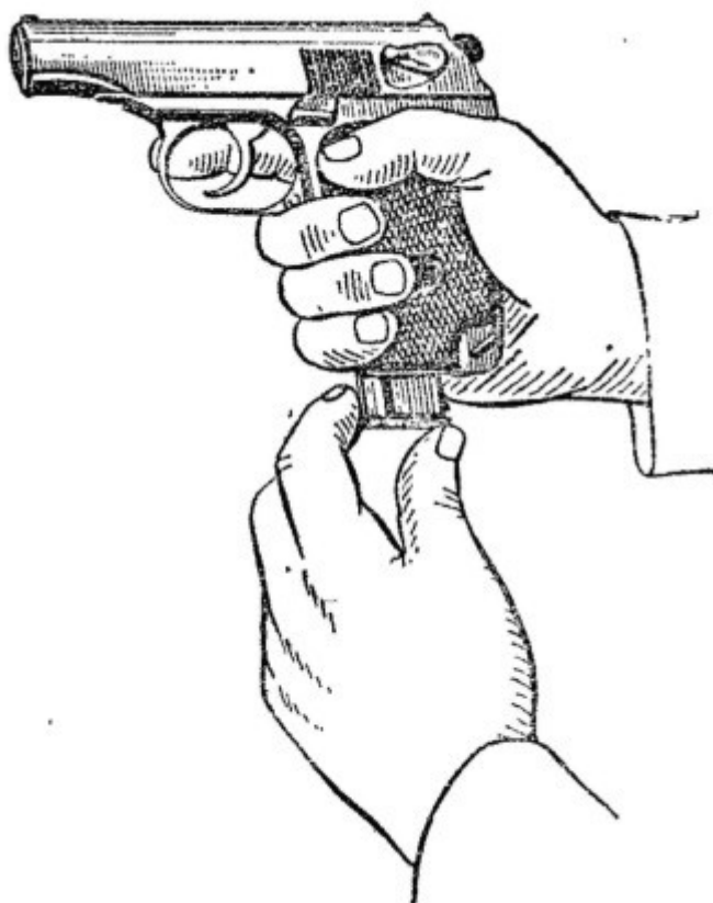
Рис. 8. Вставление магазина в основание рукоятки
