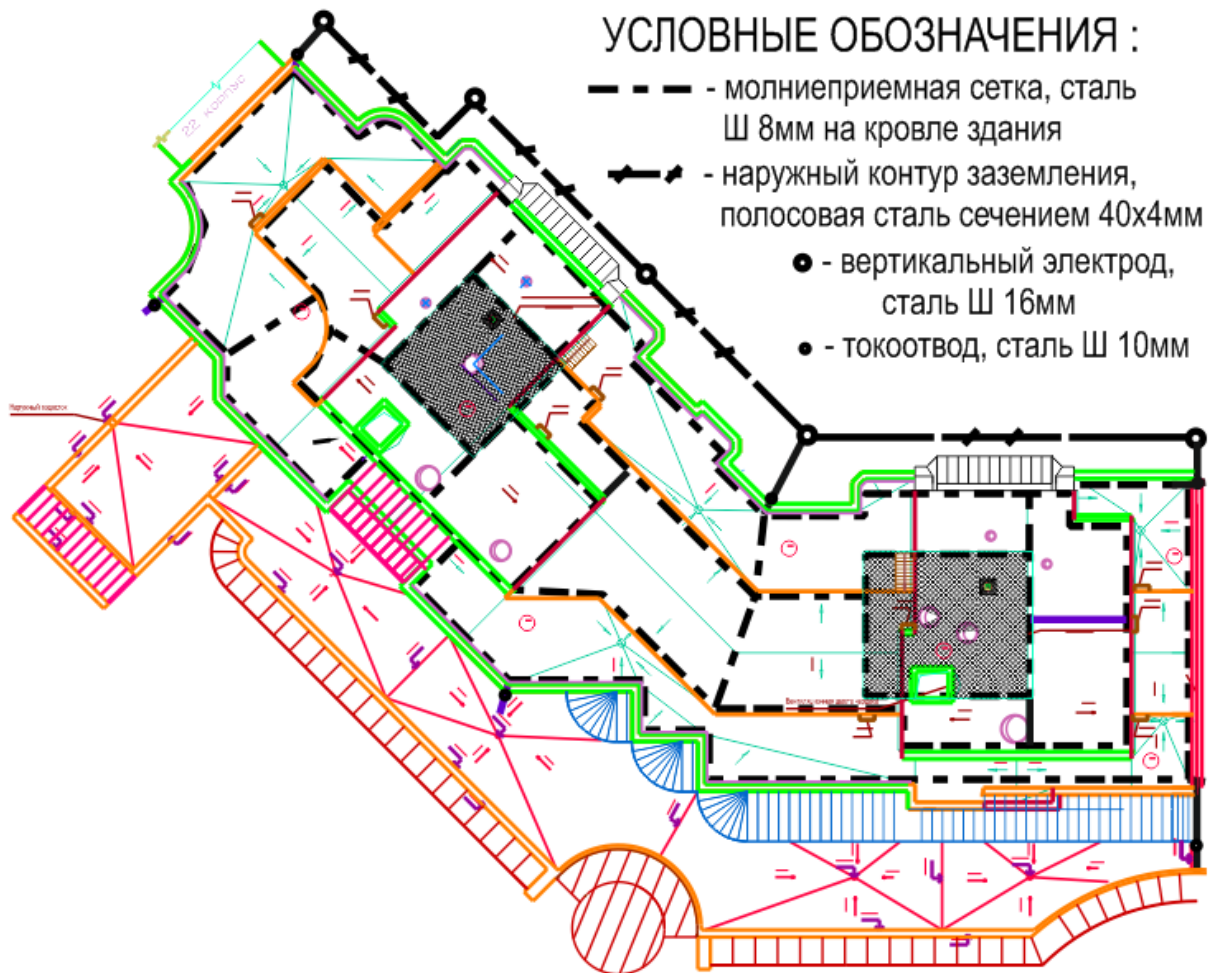
Рисунок 16.8 – Молниезащита и наружный контур заземления секции 1 дома
