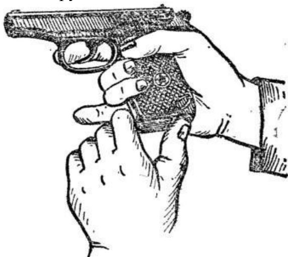
Рис. 3. Извлечение магазина из основания рукоятки
