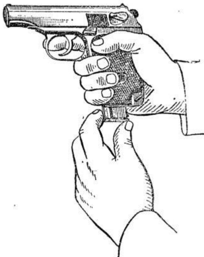
Рис. 8. Вставление магазина в основание рукоятки
