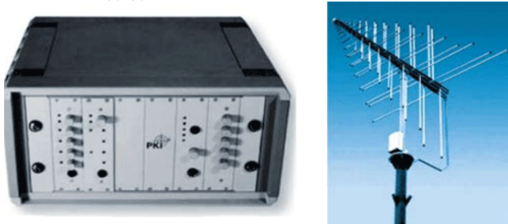
Рис. 3. Комплекс перехвата побочных электромагнитных излучений СВТ: а) специальное приёмное устройство PKI2715 (дальность перехвата ПЭМИ от 10 до 50 м); б) широкополосная направленная антенна R&SHB 007 (диапазон частот от 80 МГц до 1,3 ГГц, коэффициент усиления 5-7 дБ)
