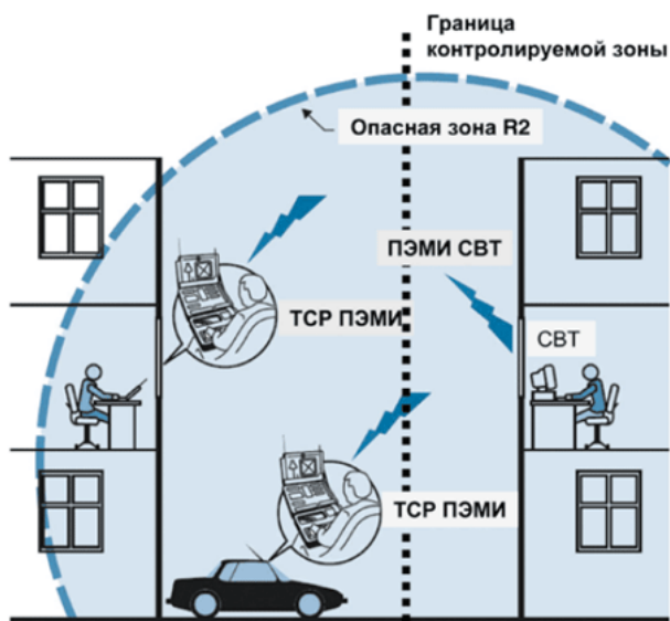
Рис. 4 – Перехват ПЭМИ от средств вычислительной техники техническими средствами разведки
