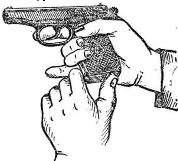
Рис. 3. Извлечение магазина из основания рукоятки
