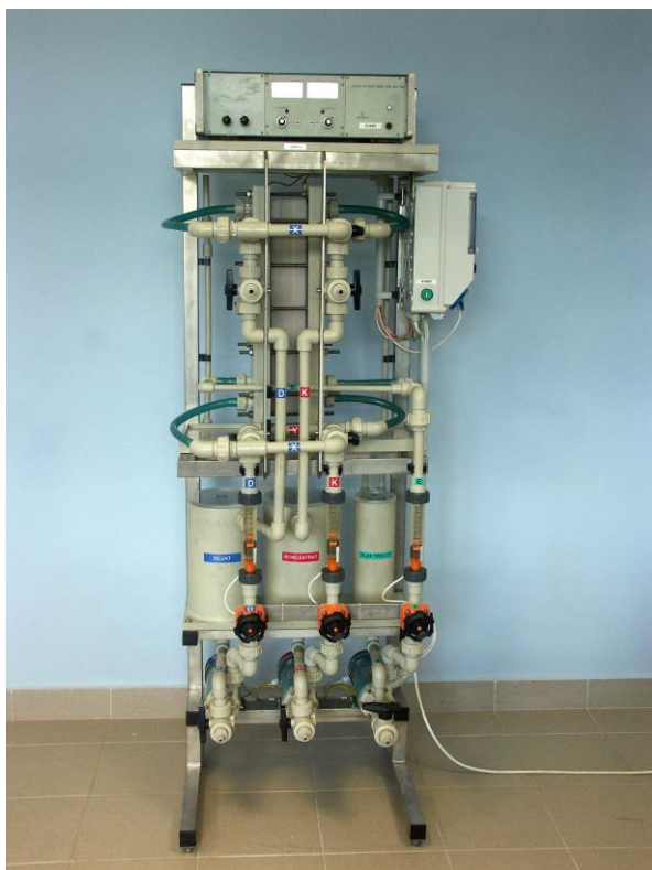
Рисунок 16 – Современный модуль для обработки лактозосодержащего сырья, используемый в международной лаборатории СевКавГТУ.
