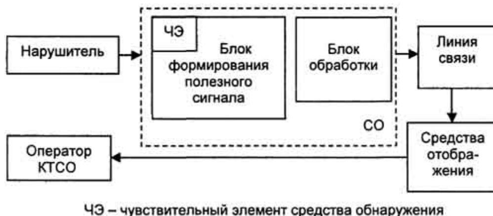
Рис. 2. Структурная схема передачи информации о наличии нарушителя
