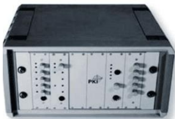
Рис. 3. Комплекс перехвата побочных электромагнитных излучений СВТ:
