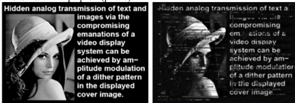
Рис. 5 – Тестовое изображение, выведенное на экран монитора (а) и изображение, перехваченное средством разведки ПЭМИ (б)
