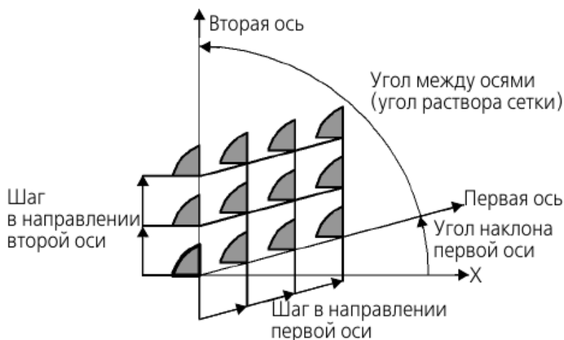
Рис. 2.7. Схема образования параллелограммной сетки
