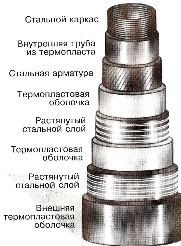
Рисунок 6.1 - Конструкция гибкого трубопровода
