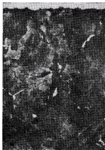
Рисунок 7. Микроструктура хромированной стали. X300
