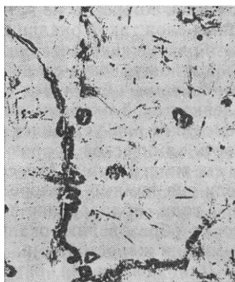
Рисунок 2. Микроструктура литой стали 110Г13Л (аустенит, карбиды). X200
