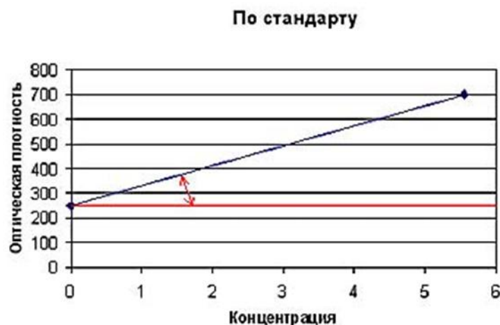
Рисунок 34 – Вид графика при калибровке по стандарту
