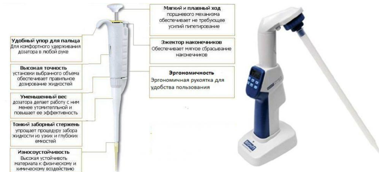
Рисунок 8 – Устройство и характеристики пипеточного дозатора
