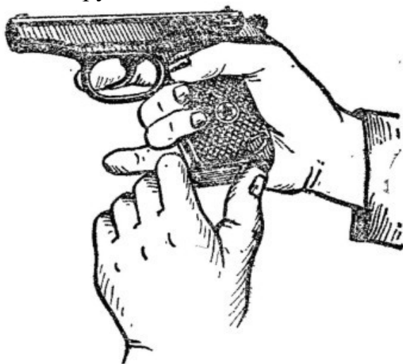
Рис. 3. Извлечение магазина из основания рукоятки
