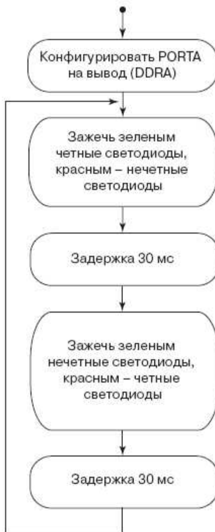
Рис.4. Блок-схема алгоритма управления светодиодами
