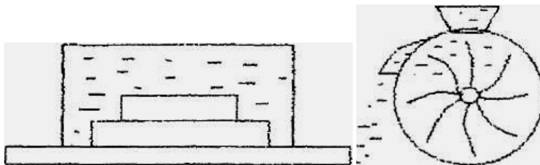
Рисунок 20 – Схема пескометной машины
