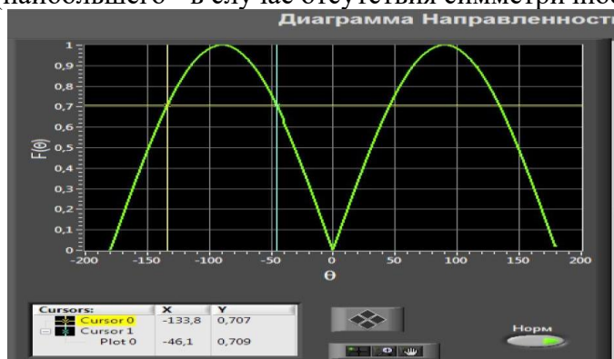
Рисунок 18. Пример определения ширины диаграммы направленности
