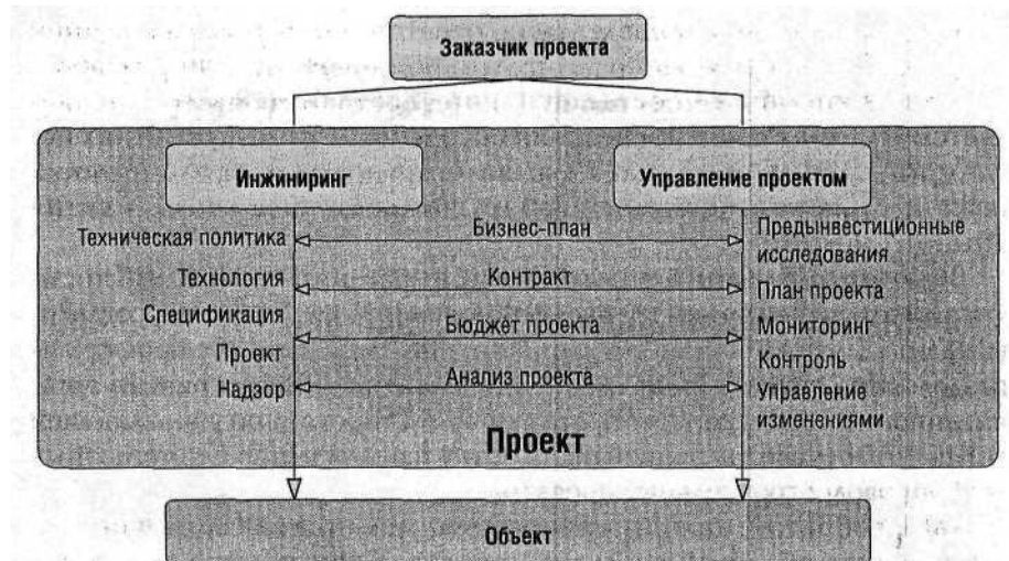
Рис. 11.1 Структура функций инжиниринга в системе управления инвестиционным проектом
