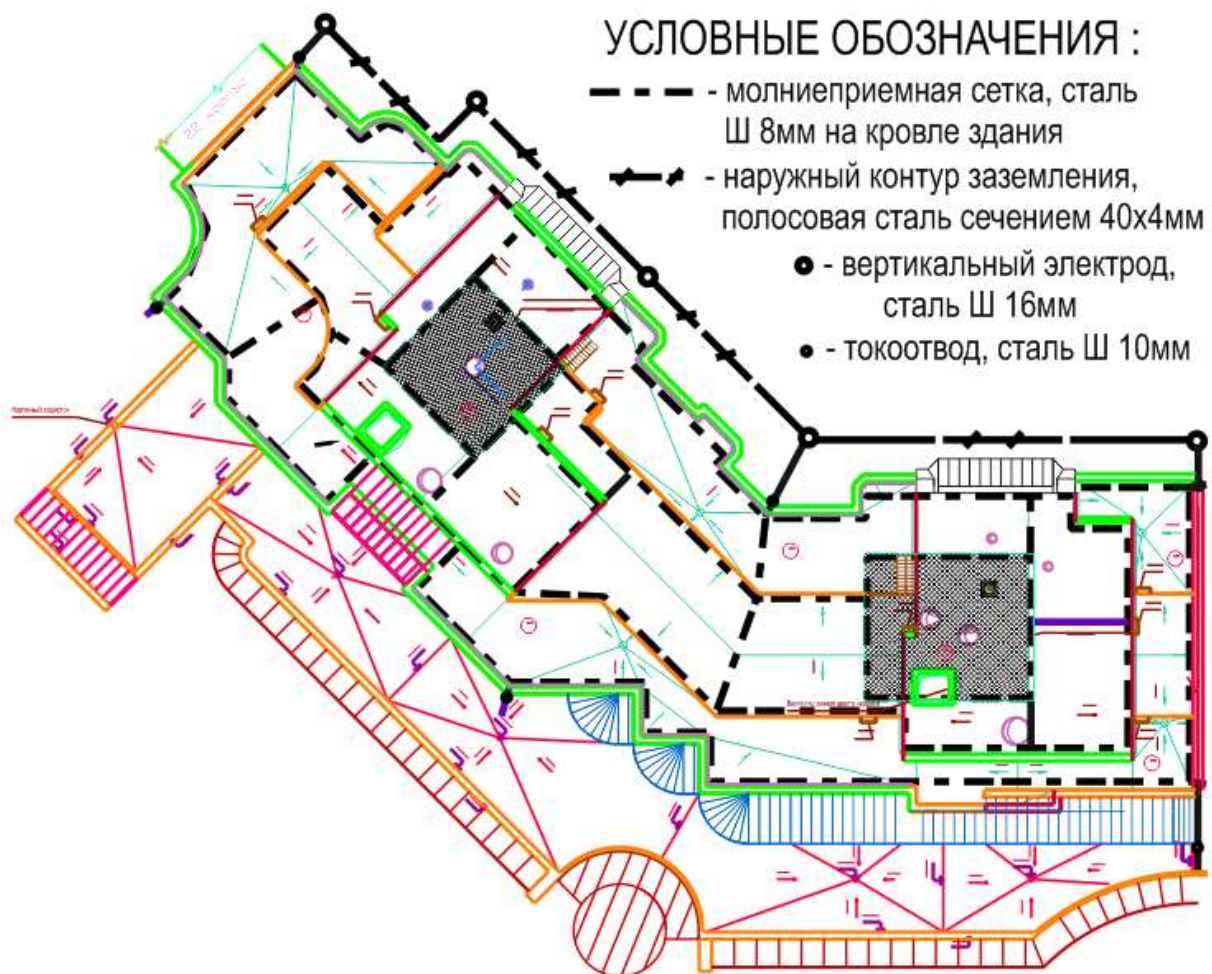
Рисунок 16.8 – Молниезащита и наружный контур заземления секции 1 дома
