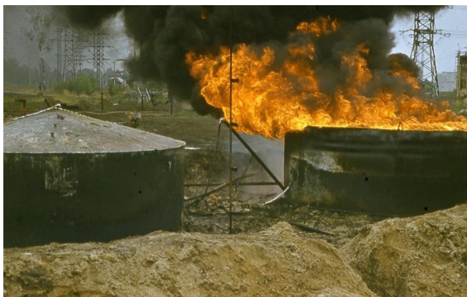
Рис. 2. Экспериментальные исследования по изучению пожарной опасности резервуара, расположенного рядом с горящим резервуаром
