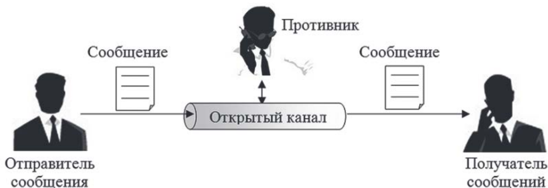
Рис. 1. Базовая модель криптографии
