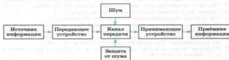
Рис. 1.19. Техническая система передачи информации
