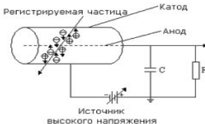
Рисунок 2. 4 – Принципиальная схема конструкции ГС
