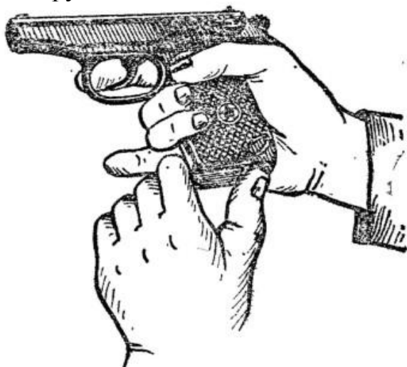
Рис. 3. Извлечение магазина из основания рукоятки
