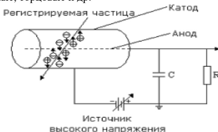
Рисунок 2. 4 – Принципиальная схема конструкции ГС
