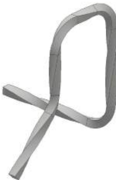
Рисунок 197 – Работа переменной «Закручивание»
