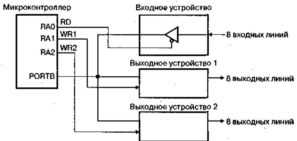
Рис. 8.28 - Реализация двунаправленной параллельной шины
