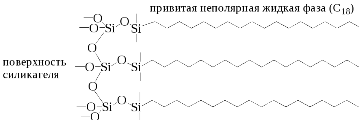
Рисунок 6 – Пример модификации силиконовой поверхности аналитической колонки октадецильными группами
