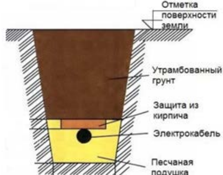
Рисунок 2.3 – Прокладка кабеля в траншее
