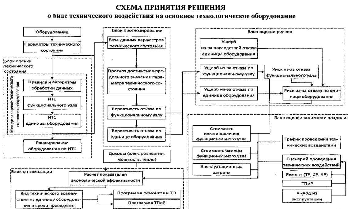
Рисунок 7.1 – Схема порядка принятия решения о виде технического воздействия на основное технологическое оборудование
