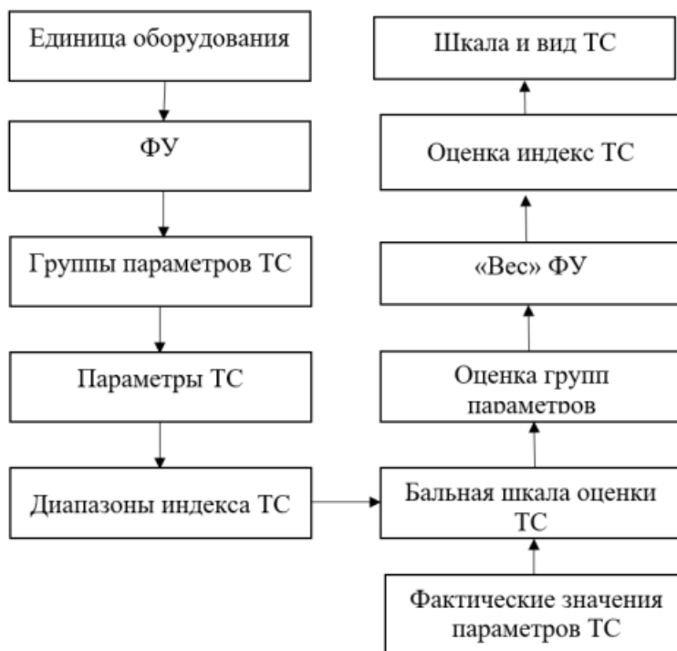
Рисунок 1.1 – Порядок оценки технического состояния энергетического объекта
