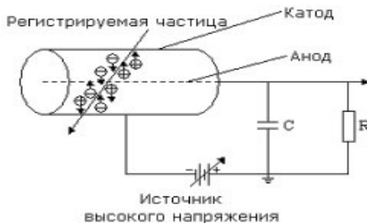
Рисунок 2. 4 – Принципиальная схема конструкции ГС
