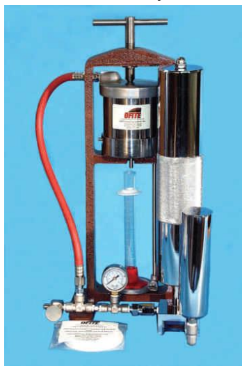
Рисунок 9 – Балластный гидравлический пресс-фильтр
