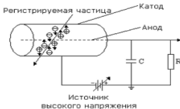
Рисунок 2. 4 – Принципиальная схема конструкции ГС
