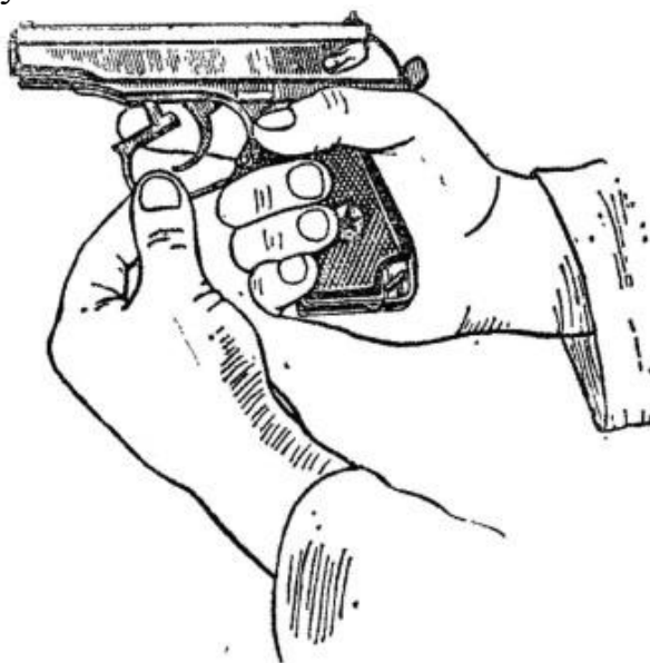
Рис. 4. Оттягивание спусковой скобы
