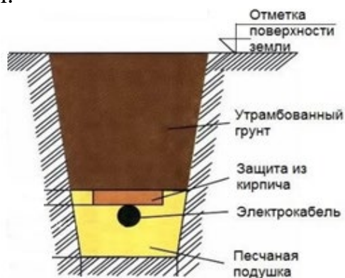
Рис. 13.3 – Прокладка кабеля в траншее
