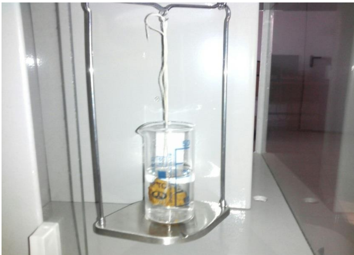
Рисунок 3.5 - Взвешивание породы в жидкости.
