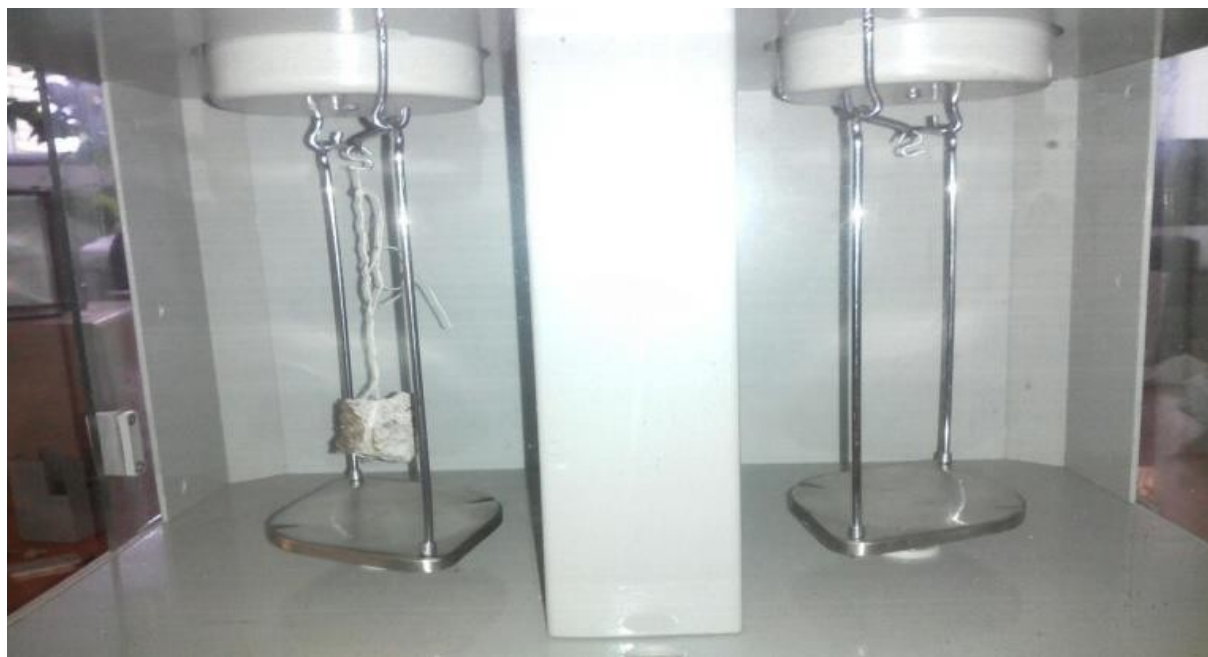
Рисунок 3.3 - Взвешивание породы в воздухе
