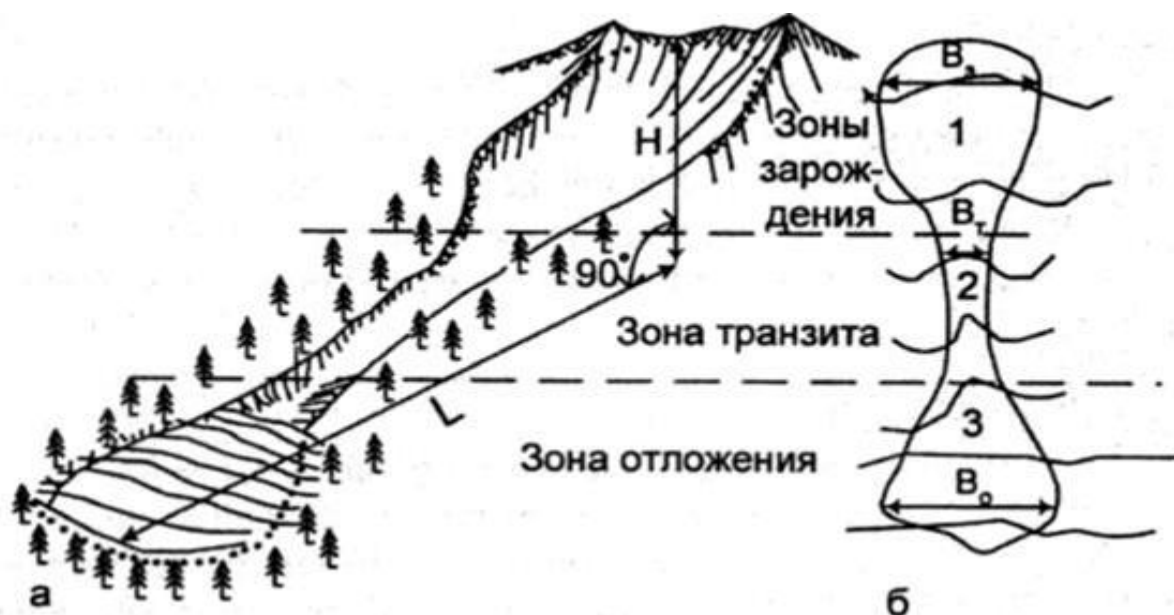
Рисунок 4.1 – Типичный лавиносбор: а) общий вид; б) границы лавиносбора на плане; 1, 2, 3 — зоны зарождения, транзита и отложения; Bз, Bт, Bо - ширина этих зон
