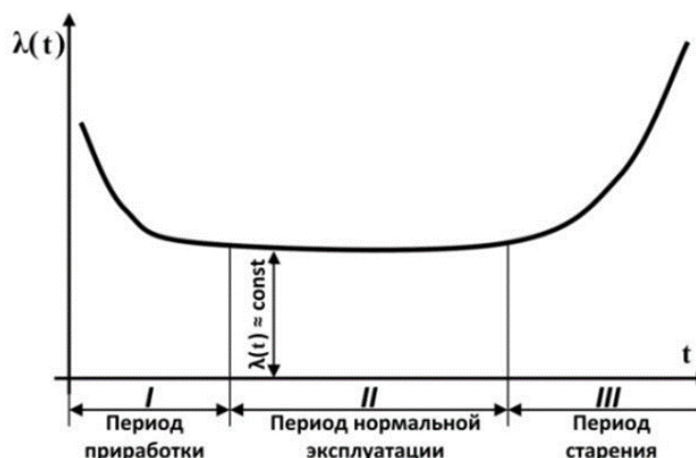
Рис. 1 – График интенсивности отказов РЭС
