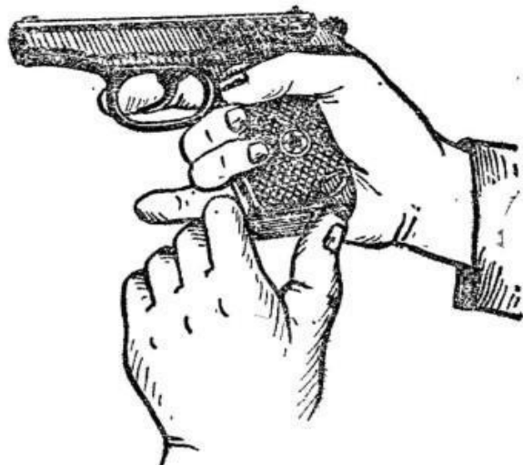
Рис. 3. Извлечение магазина из основания рукоятки
