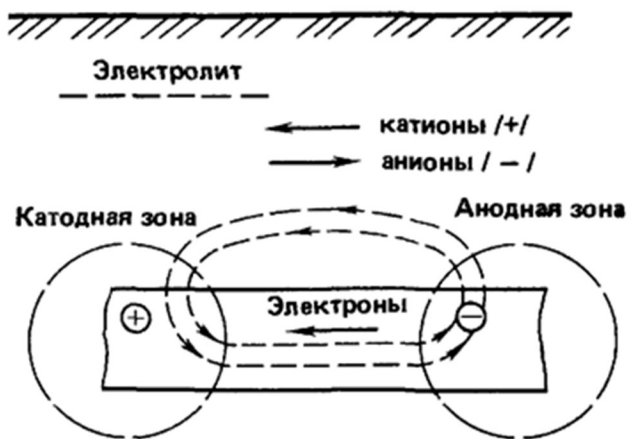
Рис. 1.1 Процесс электрохимической коррозии
