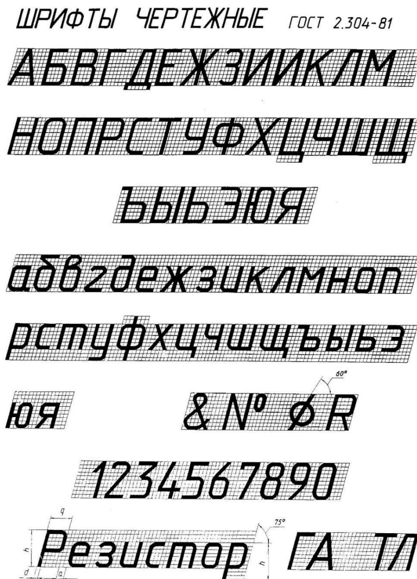
Рисунок 1.1 – Шрифт типа Б с наклоном 75^\circ
