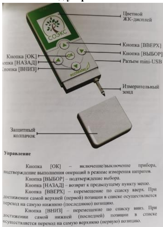
Рисунок 1 – Внешний вид экотестера «SOEKS».
