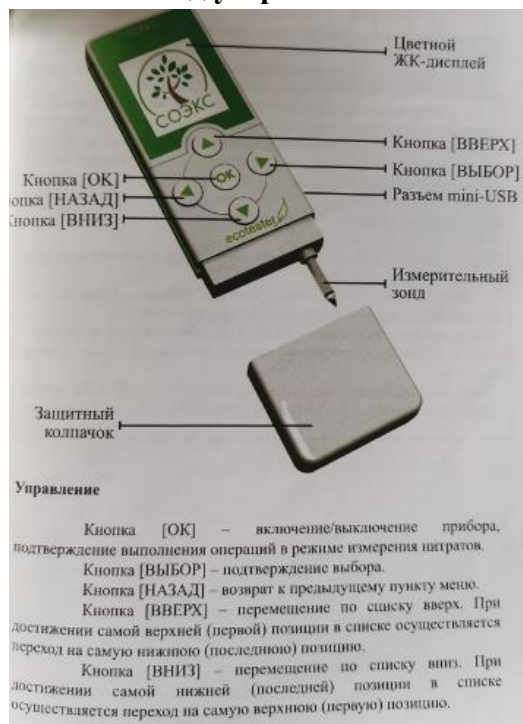
Рисунок 1 – Внешний вид экотестера «SOEKS».
