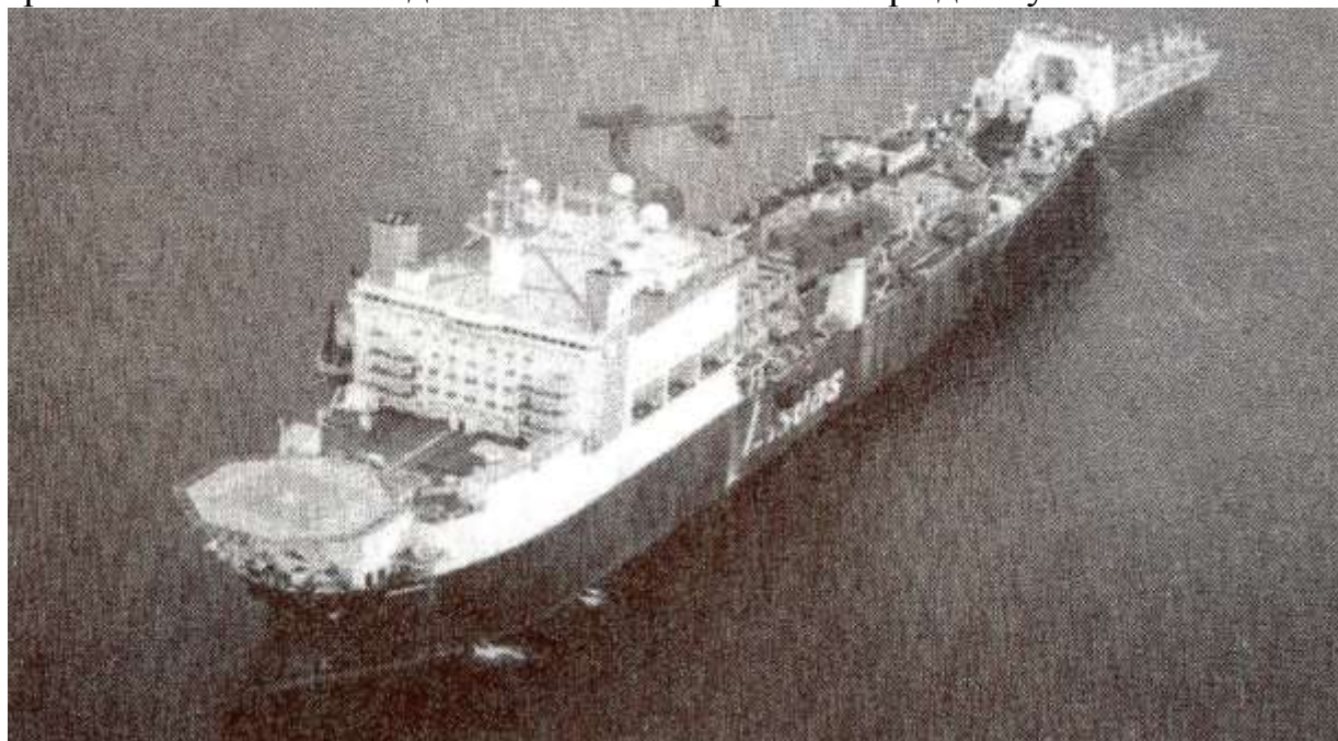
Рисунок 3 - Баржа "Solitaire" для S-образной прокладки труб
