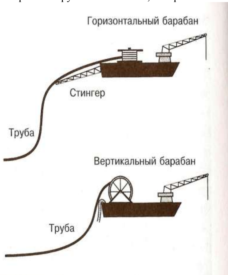
Рисунок 5 - Баржи-трубоукладчики с вертикальным и горизонтальным барабаном
