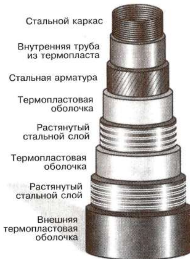
Рисунок 1 - Конструкция гибкого трубопровода
