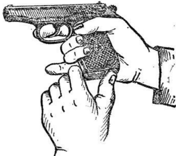
Рис. 3. Извлечение магазина из основания рукоятки
