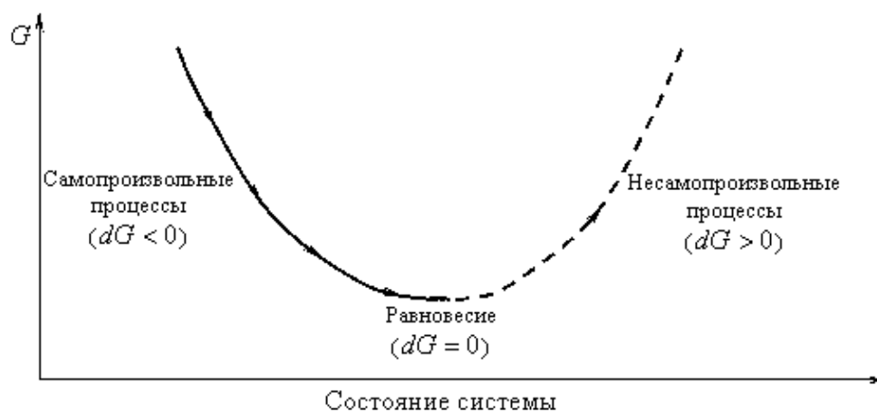
Рисунок 6.1 – Изменение энергии Гиббса закрытой системы при p = \text{const} , T = \text{const}
