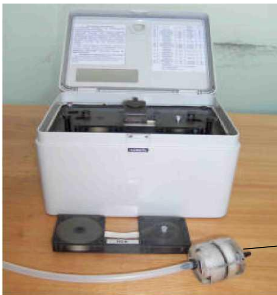
Рисунок 3.2 – Общий вид газоанализатора ГАНК-4
