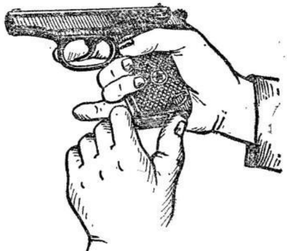
Рис. 3. Извлечение магазина из основания рукоятки
