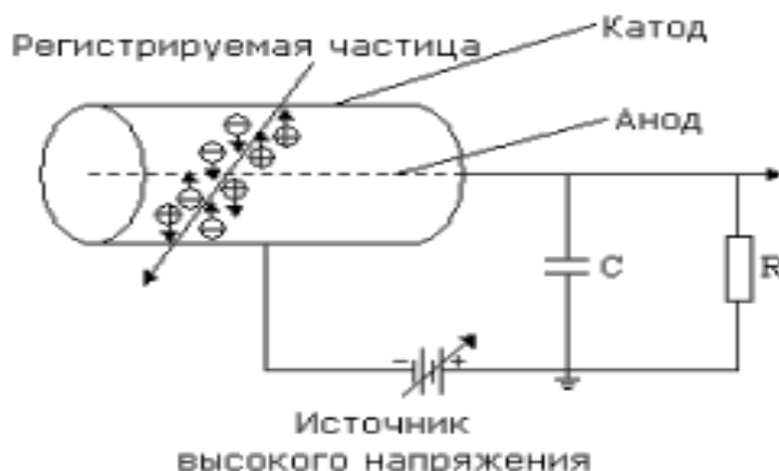
Рисунок 2. 4 – Принципиальная схема конструкции ГС
