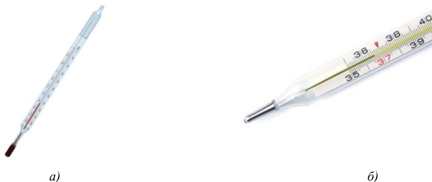
Рис. 3. Жидкостные термометры (слева – спиртовой, справа – ртутный).
