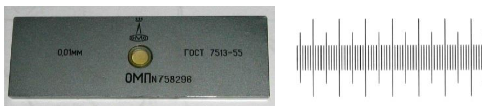
Рис. 7. Внешний вид и шкала объект-микрометра
