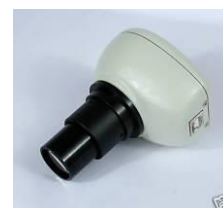
Рис. 4. Микроскоп «Premiere» и usb камера, вставляемая вместо окуляра
