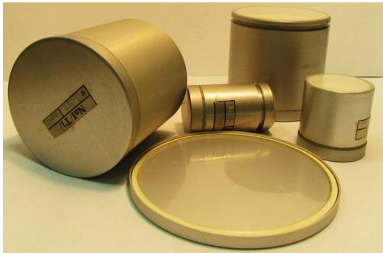
Рисунок 3.10 - Внешний вид сцинтиллятора (йодистый натрий, активированный таллием)
