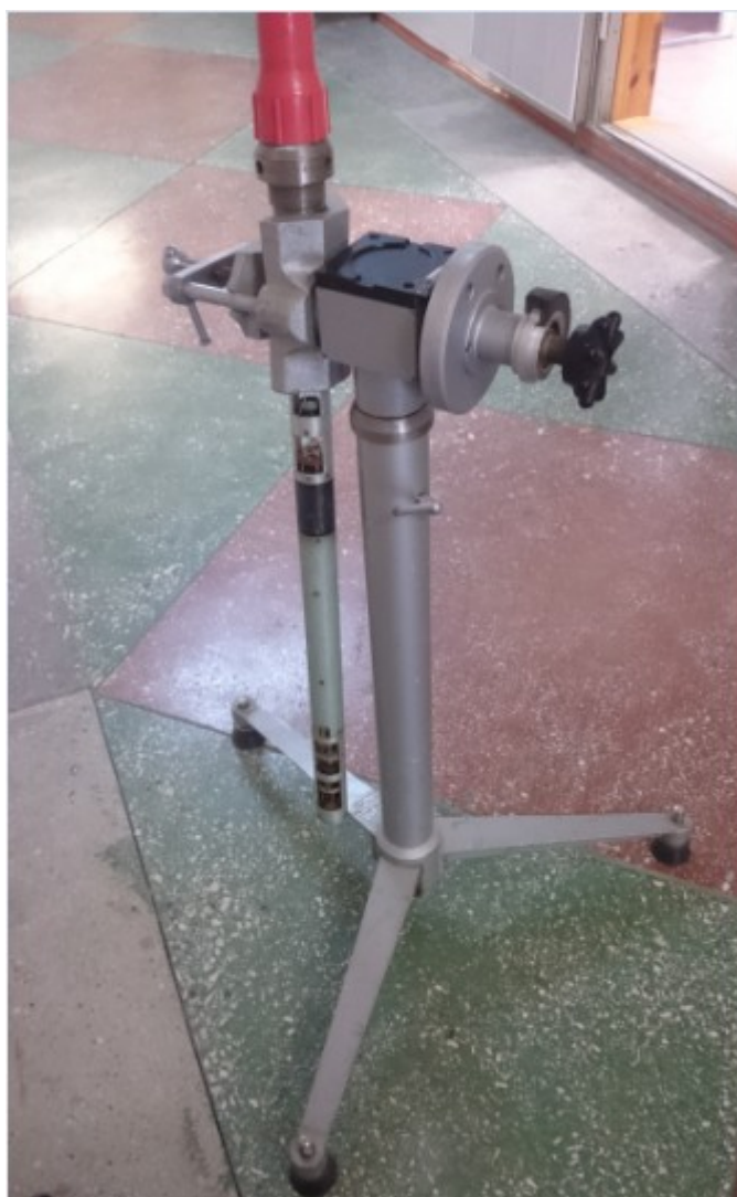
Рисунок 8.3 – Инклинометр на калибровочной установке
