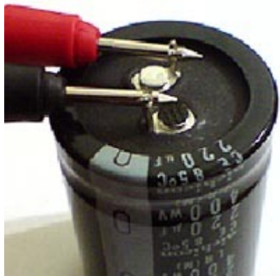
Рисунок 1.9 – Как необходимо прозванивать конденсатор
