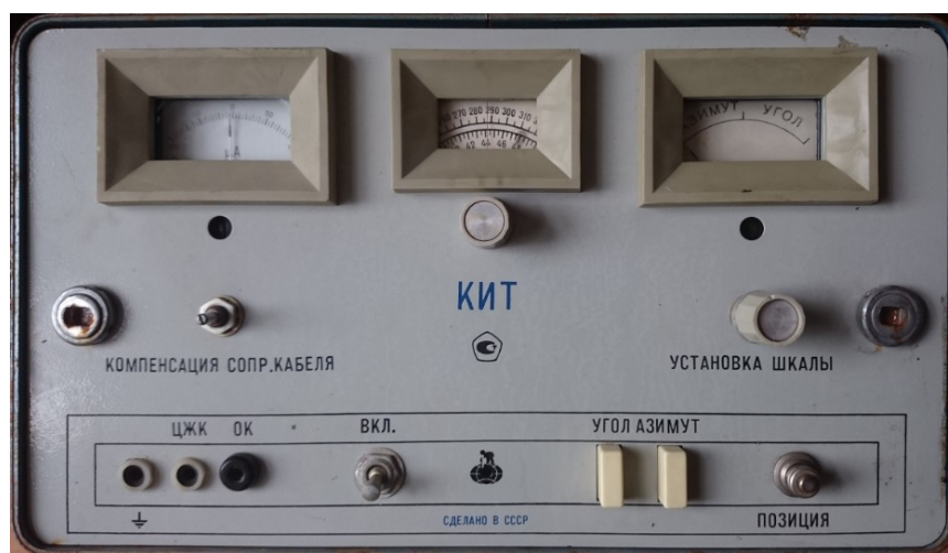
Рисунок 8.2 – Наземная панель инклинометра КИТ
