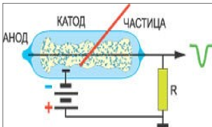
Рисунок 3.3 – Принципиальная схема газонаполненного детектора ионизирующего излучения
