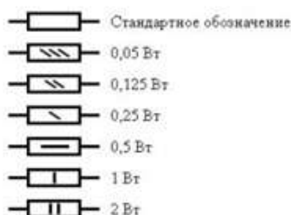
Рисунок 3. Мощность постоянных резисторов
