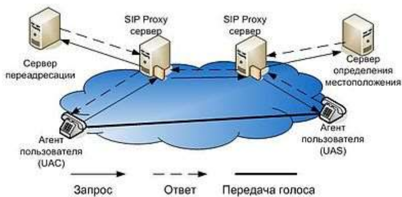
Рисунок 2. структурная схема соединения, использующего SIP протокол
