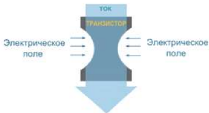
Рисунок 11. Принцип действия полевого транзистора
